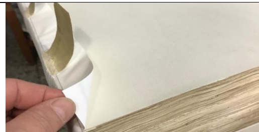
L'incorporatura e le fettucce in pergamena saranno splittate all'interno dei cartoni dei piatti per un sostegno più forte
